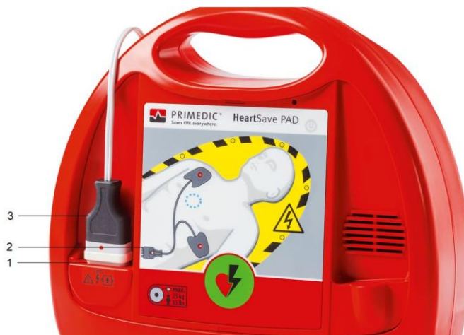
Fig. 14: Insertar los conectores de los electrodos
