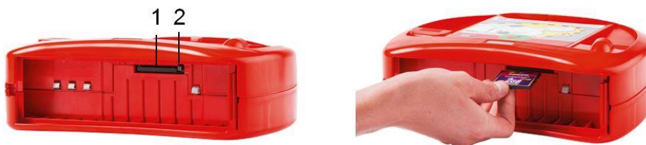
Fig. 7: Inserción / sustitución de la SaveCard
